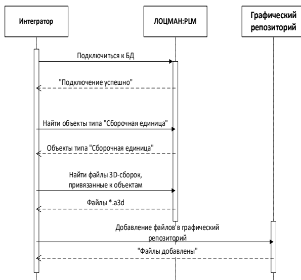
Рис. 2. Взаимодействие акторов (Интегратор, ЛОЦМАН:PLM, Графический репозиторий) в процессе интеграции
