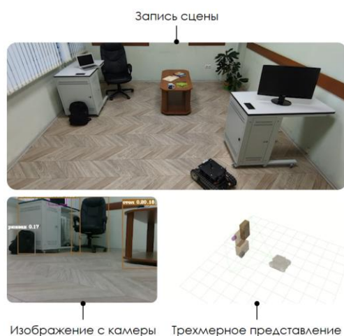
Рис. 3. Экспериментальные исследования метода на мобильном роботе
