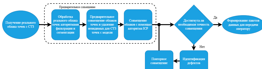
Рис. 1. Обобщенная схема алгоритма поиска характерных особенностей и дефектов
