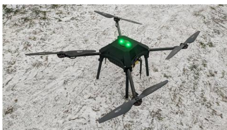
Рис. 3. Прототип БпЛА с промежуточным узлом связи
