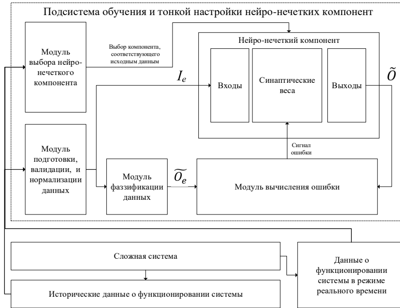
Рис. 3. Компоненты подсистемы обучения и тонкой настройки нейро-нечетких компонент (ННК)
