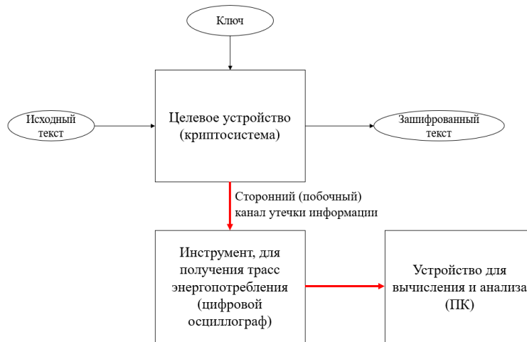
Рис. 2. Структура стенда для проведения атаки по энергопотреблению.
