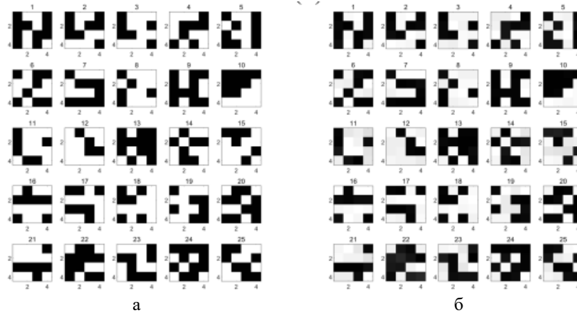
Рис. 7. Процесс обучения сжатию и реконструкции изображений: а – входное двоичное изображение в размерности 4 \times 4 ( x, 0, 1, M = 25 ). Эти изображения необходимо закодировать как амплитуды 3-кубитных состояний. б – результаты реконструкции изображения
