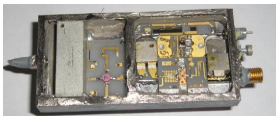
Рис. 2. Фото генератора со снятой крышкой
