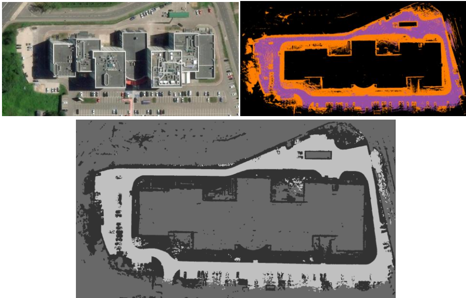
Рис. 3. Вид сверху на офисное здание (слева сверху). Накопленное семантическое облако точек (справа сверху), оранжевым показаны точки классов препятствий, фиолетовым – свободных и априорная карта занятости офисного помещения (снизу)
