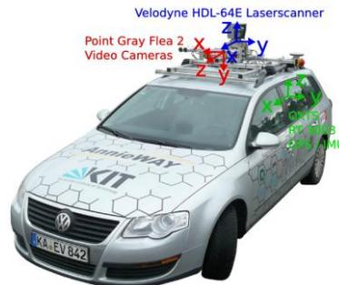
Рис. 1. Измерительный стенд, используемый для записи набора данных KITTI
