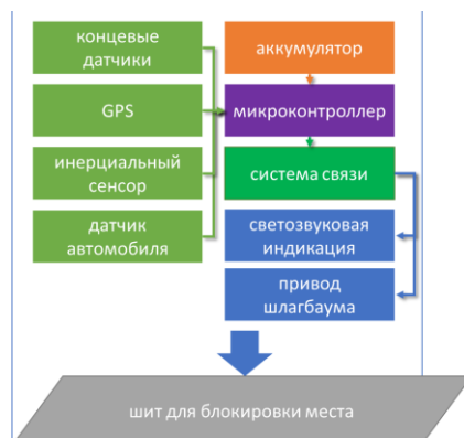
Рис. 2. Схема устройства для управления парковочными местами
