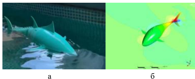
Рис. 2. Внешний вид туниморфного БПР (а) и соответствующей ему гидродинамической модели (б)
