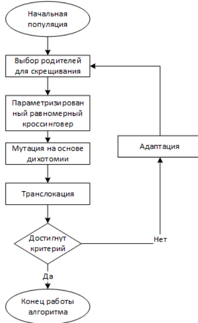
Рис. 4. Структурная схема генетического алгоритма
