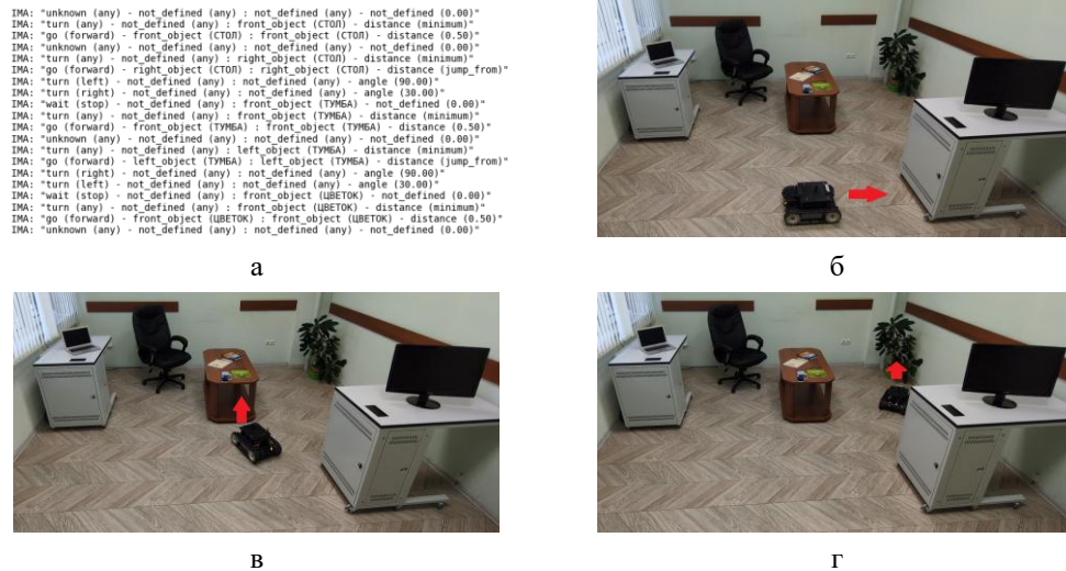
Рис. 5. Выполнение роботом сценария «go_to_goal»: а – маршрут на LRNB; б – движение к ориентиру «СТОЛ»; в – движение к ориентиру «ТУМБА»; г – движение к ориентиру «ЦВЕТОК»
