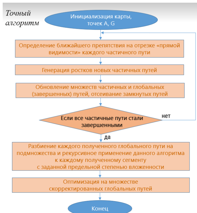
Рис. 1. Обобщенная блок-схема точного алгоритма планирования по методу характеристического графа видимости
