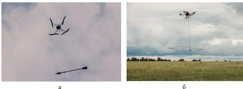
Рис. 2. Применение беспилотных летательных аппаратов для поиска ВОП: а – с магнитометром; б – с металлодетектором
