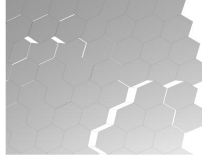
Рис. 4. Поверхность рефлектора, состоящая из шестиугольников
