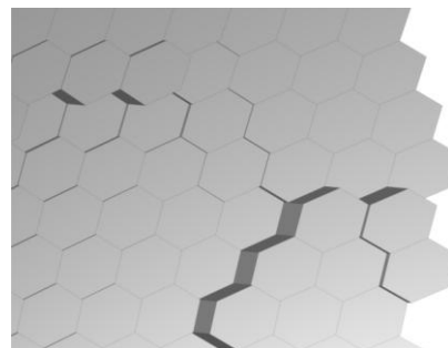
Рис. 6. Поверхность рефлектора, состоящая из объемных фигур
