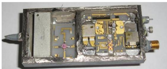
Рис. 2. Фото генератора со снятой крышкой
