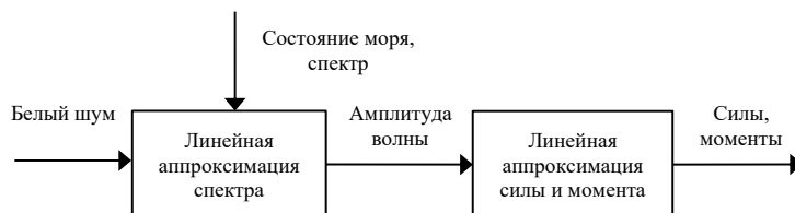
Рис. 5. Схема формирования сил и моментов внешнего возмущения
