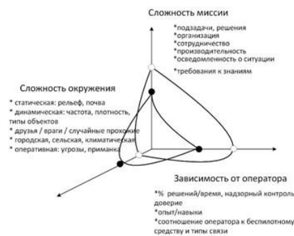
Рис. 1. Пример показателей для определения уровня автономности, предложенные группой ALFUS («пространство автономии»)
