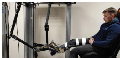
Рис. 7. Экспериментальный образец тренажерного комплекса для восстановительной механотерапии
