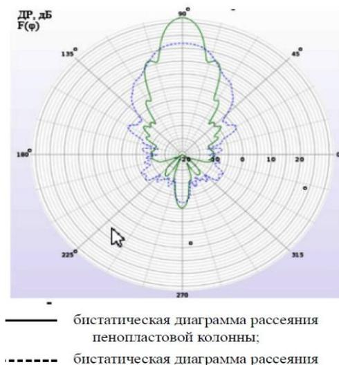
Рис. 1. Сравнение бистатических диаграмм обратного рассеяния пилона и колонны
