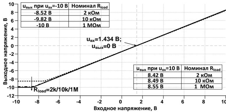
Рис. 7. Амплитудная характеристика ВК на рис. 3
