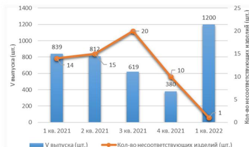
Рис. 6. Гистограмма объема выпуска и количества несоответствующей продукции датчиков давления за 5 кварталов.
