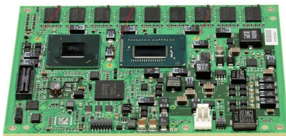
Рис. 1: Дополнительные монтажные отверстия в модуле COM Express
