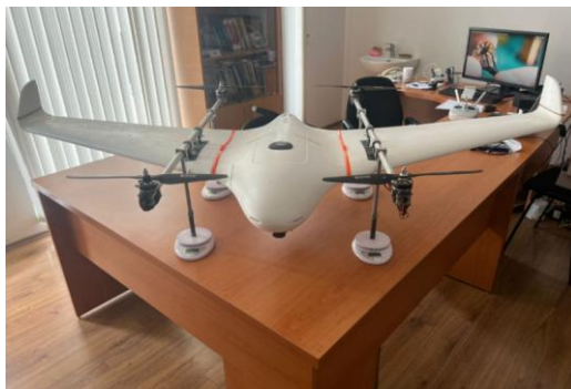
Рис. 4. Рабочее место, подготовленное в лаборатории с целью определения ЦТ БПЛА конвертопланового типа
