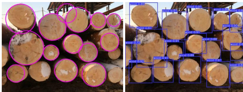
Рис. 3. Результат подсчета количества бревен для метода с использованием математической морфологии и метода на основе сверточных нейронных сетей на примере изображения из Интернета
