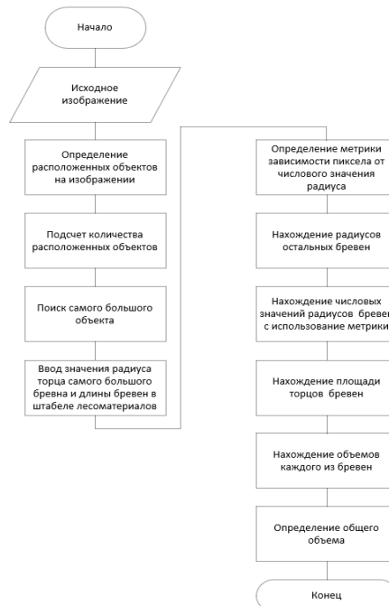
Рис. 2. Блок-схема алгоритма для нейросетевого метода по определению геометрических параметров объектов на изображении
