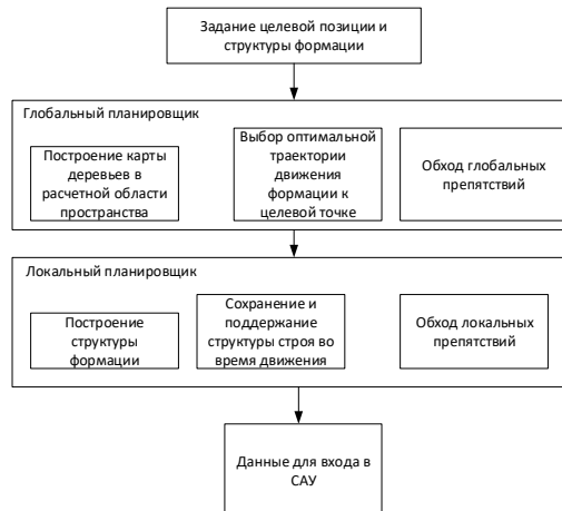
Рис. 2. Схема разрабатываемого алгоритма двухуровневого планирования
