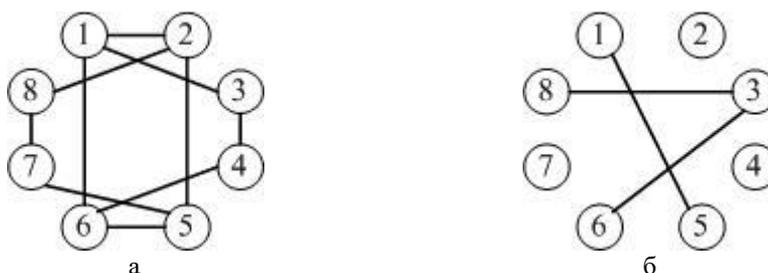
Рис. 4. Плоский граф: а – со стороны пайки; б – со стороны установки ЭРЭ
