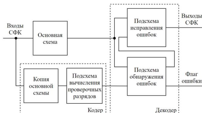
Рис. 1. Общая структура схемы функционального контроля
