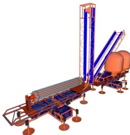
Рис. 3. Подводная буровая установка на базе двух роботизированных шагающих платформ
