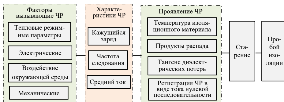
Рис. 1. Алгоритм процесса старения и пробоя изоляции
