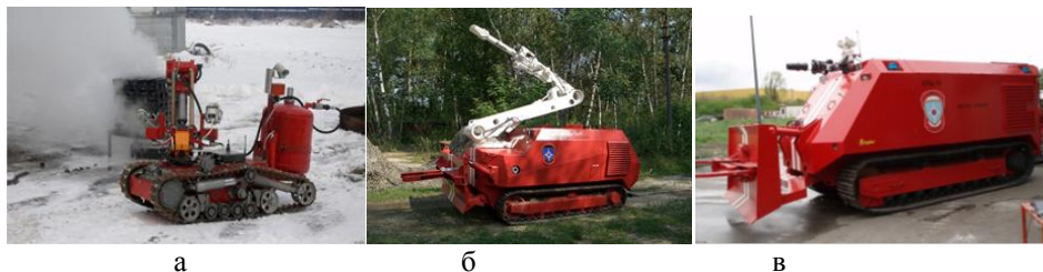
Рис. 3. Принятые на вооружение МЧС России образцы пожарных МРК
