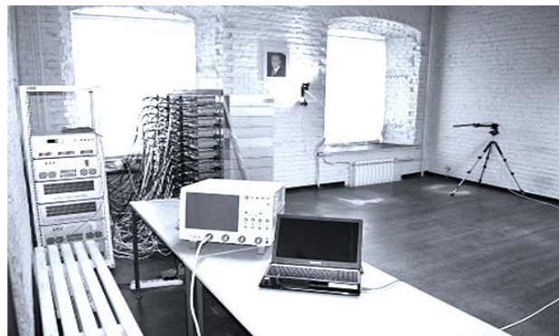
Рис. 3. Стойка питания и управления, излучающая система, осциллограф, ПК, преобразователь импульсного электромагнитного поля
