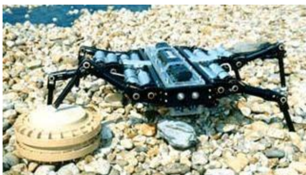
Рис. 8. Подводный шагающий робот ArieI-II (США) предназначенный для сбора противодесантных мин в зоне прибоя
