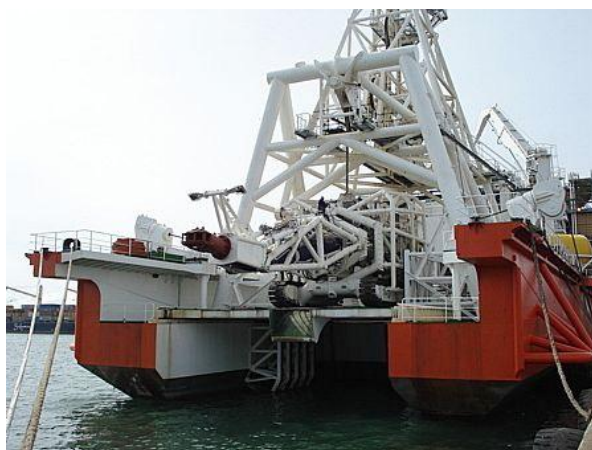
Рис. 5. Подводный добычный гусеничный модуль компании «De Beers Marine» на борту судна производственной поддержки
