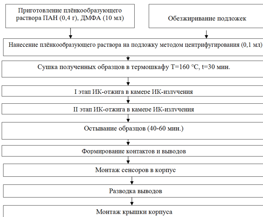
Рис. 1. Схема технологического процесса изготовления сенсора на основе кобальтсодержащего ПАН
