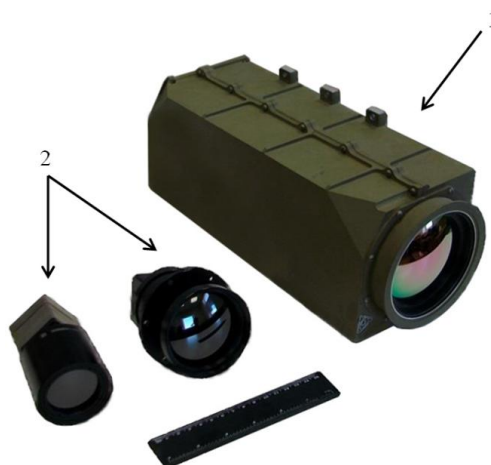
Рис. 1. Сравнительные размеры охлаждаемого тепловизора ТППП1-Е (аналога тепловизора (MATIS-LR) (1) и неохлаждаемых тепловизоров (2)
