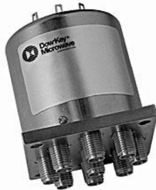
Рис. 9. Электромеханический коммутатор DowKey 581-420802A (1 вход, 8 выходов, 0...18 ГГц, 50 Ом, потери на частоте до 4 ГГц 0,2 дБ при максимальной мощности до 100 Вт)
