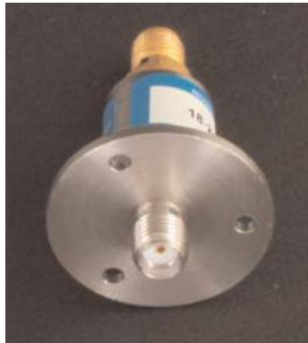
Рис. 13. Вращающийся коаксиальный переход Diamond satcom 18-2124-0 (SMA, 0–18 ГГц, потери до 0,3 дБ, мощность до 200 Вт)
