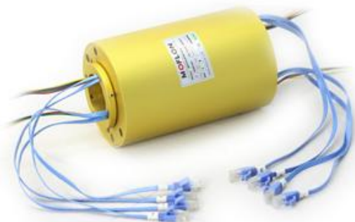
Рис. 15. Вращающийся переход серии ME2121 (Ethernet 1000BaseT, до 24 контактов общего назначения, ток до 10 А)
