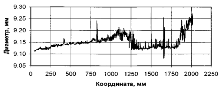
Рис. 3. Диаметр оболочки тепловыделяющего элемента до химической отмывки
