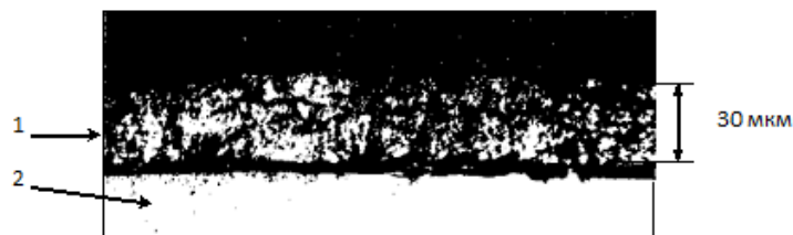
Рис. 1. Отложения на поверхности оболочки твэла ТВС на расстоянии 660 мм от нижнего торца сердечника: 1 – отложения; 2 – оболочка твэла
