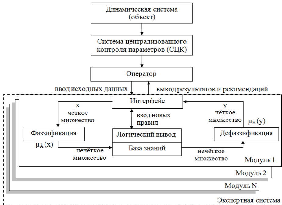
Рис. 1. Структурная схема экспертной системы на базе нечёткой логики
