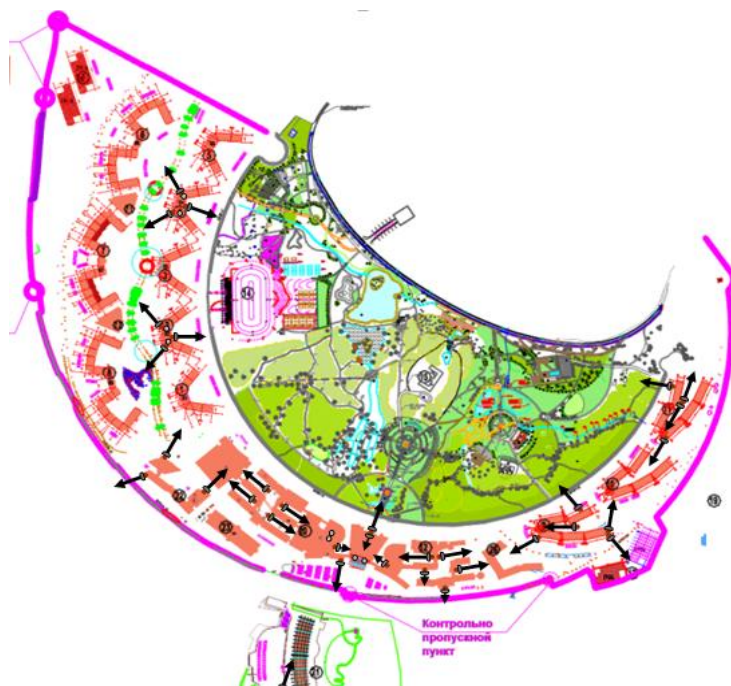
Рис. 2. Размещение передающего оборудования в корпусах кампуса ДВФУ
