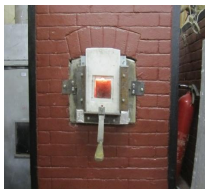
Рис. 2. Образец загружен в печь
