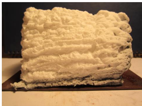
Рис. 6. Форма пенококсов, образующегося под воздействием пламени на защищенной огнезащитной краской металлической поверхности
