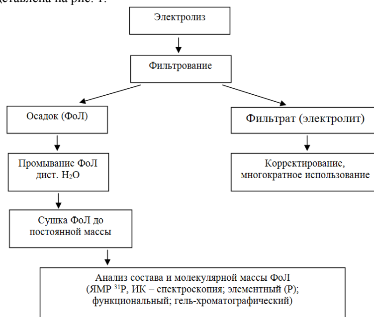
Рис. 1. Технологическая схема фосфорилирования лигнина
