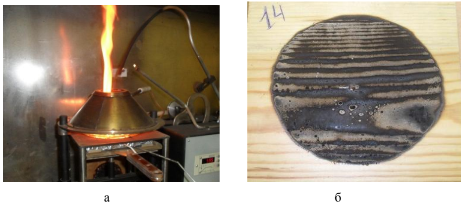
Рис. 2. Проведение огневых испытаний образцов древесины с ЛКМ (система №5) по ГОСТ 30402-96 (а), и образование обугленной пленки ЛКМ (система №5) на поверхности древесины в результате внешнего теплового воздействия (б)
