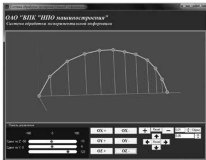
Рис. 2. Исследование изгибных колебаний стержня с шарнирным вариантом закрепления
