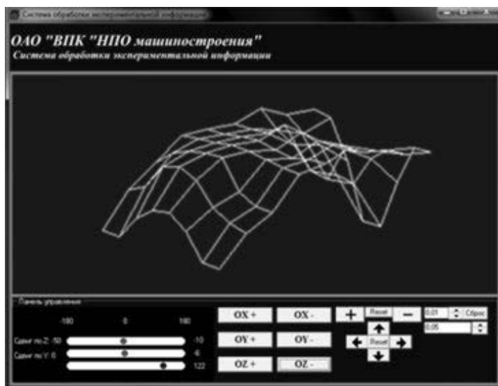
Рис. 3. Исследование изгибных колебаний печатной платы с жестким вариантом закрепления
