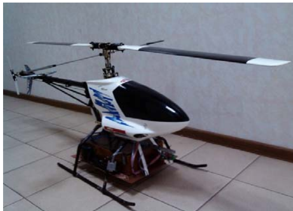
Рис. 1. Мини-вертолет с бортовой системой измерений в сборе
