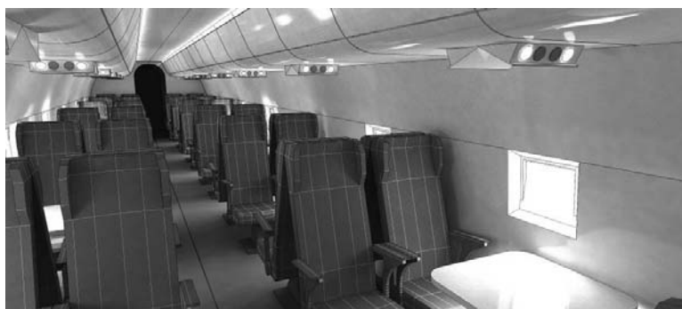
Рис. 12. Визуализация салона самолета купейной компоновки
