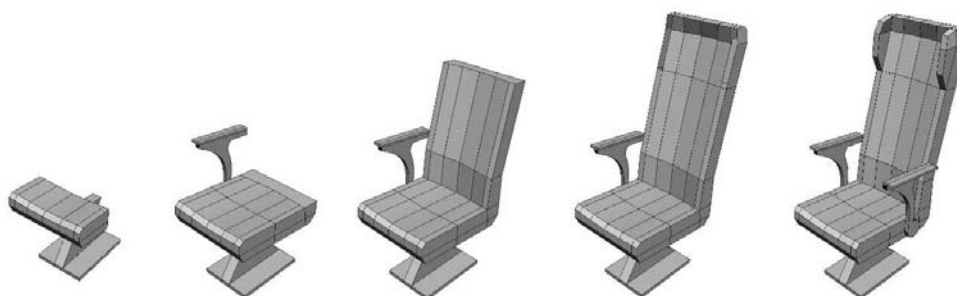
Рис. 10. Создание модели кресла методом Polygon Extrude
