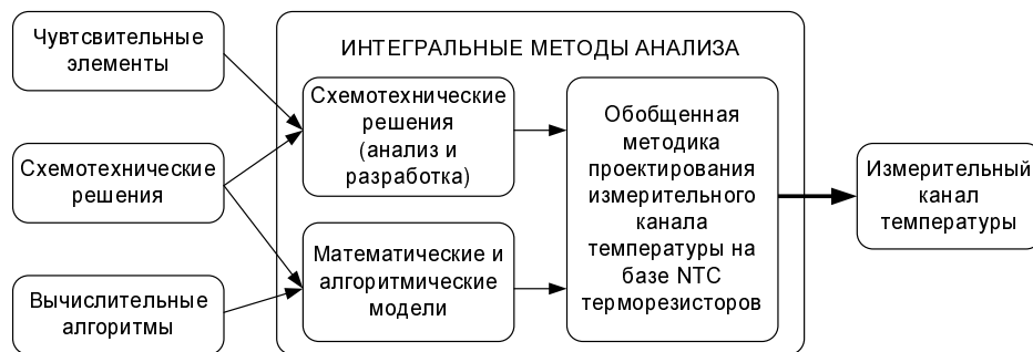
Рис. 1. Этапы реализации интегральных методов анализа элементов измерительного канала температуры на базе NTC терморезистора
