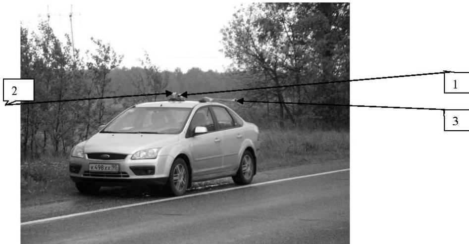
Рис. 3. Регистрирующие блоки экспериментального образца комплекса, установленные на легковом автомобиле: 1 – вперёд смотрящая камера; 2 – боковая камера; 3 – камера бесконтактного одометра
