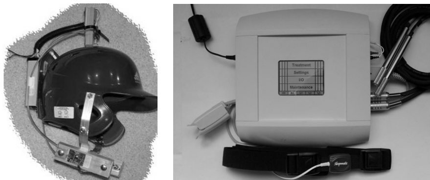
Рис. 3. Аппарат лазерной терапии нейродегенеративных заболеваний (слева) и компьютерное устройство биоуправляемой лазерной терапии и хронодиагностики (справа). Фирма Netway, США
