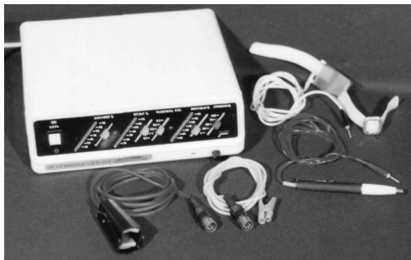
Рис. 1. Аппарат “Гармония” для электрофореза, лазерной и электротерапии с биоправлением по сигналам с датчиков пульса и дыхания (выпускался в 1990-1995 гг. МГП “ОЭМС” Москва и НПО «Электрон» г. Казань)
