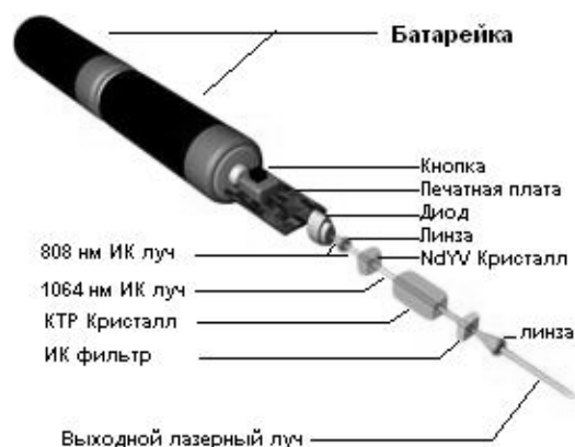
Рис. 2. Устройство лазерной указки
