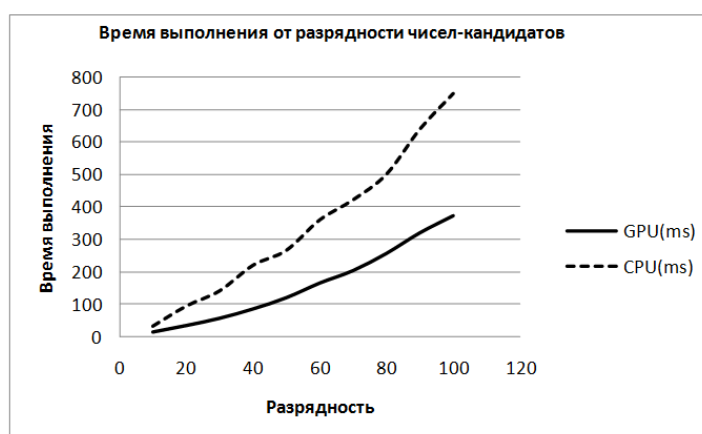
Рис. 2. Зависимость времени выполнения от разрядности чисел
