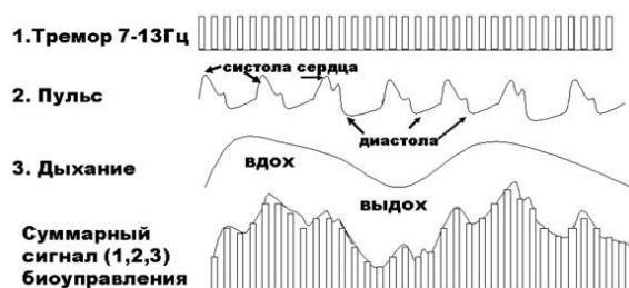
Рис. 2. Биосинхронизация физиотерапевтических воздействий по сигналам с датчиков пульса и дыхания пациента
