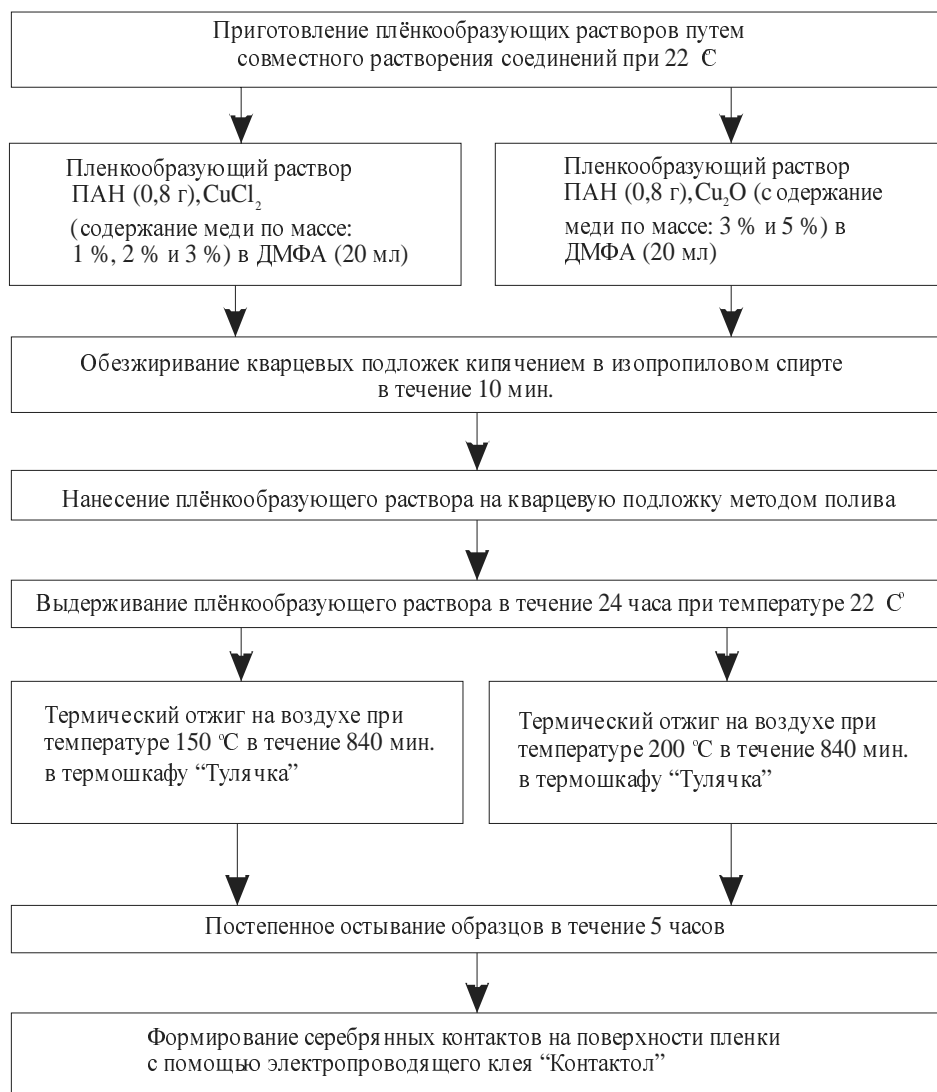
Рис. 1. Технологическая схема получения сенсорных элементов состава ПАН/ CuO_x
